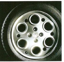
ABS à trois voies et quatre capteurs. Pneumatiques taille basse. Disques avoutés à diamètre majoré. Le dessin des jantes en alliage de 15" a été étudié pour favoriser le passage de l'air afin d'avoir un dégagement optimal de la chaleur accumulée par le système de freinage.
